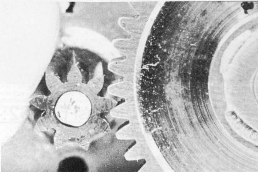
För löst! Det kanske går bra en stund, men dreven slits fort och snart börjar det låta vid inbromsningar. Efter ytterligare en stund är dreven förstörda.
